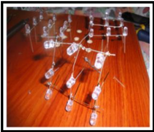
Figura 5: Niveles del cubo. Cátodo común
