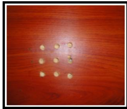
Figura 3: Plantilla de madera para montaje de los leds.
