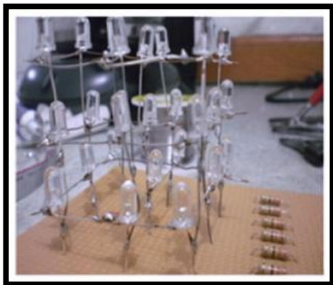
Figura 6: Leds soldados formando el cubo
